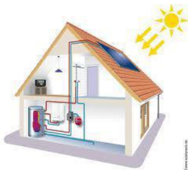
Figure 68: schéma de principe de fonctionnement des capteurs solaires thermiques
