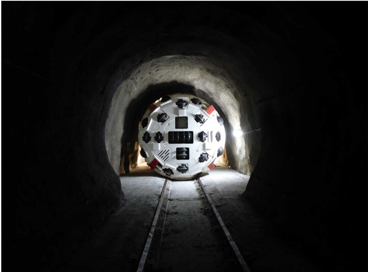
Tunnelier roche dure DN 3,5 m
