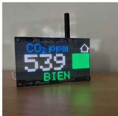
Figure 20 : Capteur Module Air évaluant la concentration en CO<sub>2</sub> de l'air intérieur (crédits photo : Olivier Martocq/Radio France)
