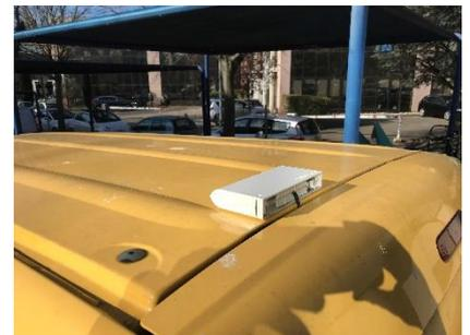
Figure 46 : Capteur installé sur le toit d'un véhicule de La Poste
