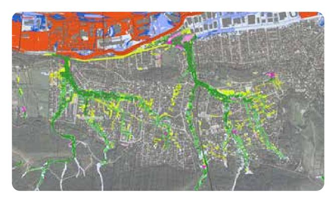
Cartographie de l'aléa ruissellement sur les Pennes / Huveaune, en s'appuyant sur une grille d'aléa en test, qui permet de bien distinquer ruissellement et écoulement.
