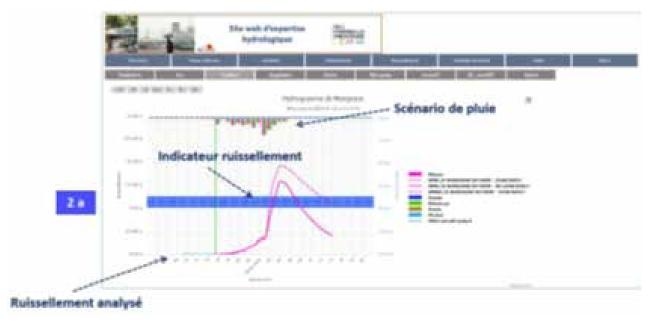
Diagnostic de ruissellement en test sur la métropole. A droite, vision synoptique sur la base d'un scénario de pluie. Un indicateur de ruissellement est qualifié en termes de période de retour: 2, 10 et 50 ans (voir échelle). A droite, le graphe représente l'évolution de cet indicateur à Aubagne: période de retour compris entre 2 et 10 ans.
