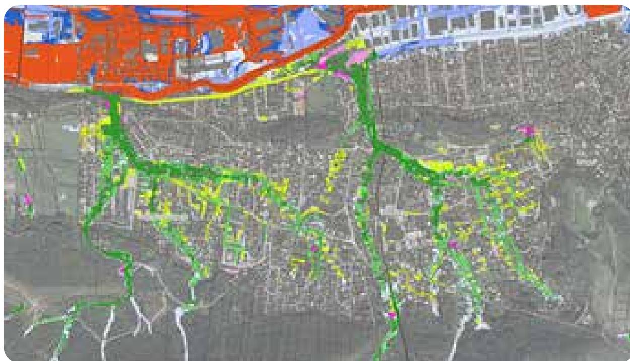
*Cartographie de l'aléa ruissellement sur les Pennes / Huveaune, en s'appuyant sur une grille d'aléa en test, qui permet de bien distinguer ruissellement et écoulement.*
